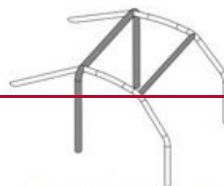
1 főbukócső / main rollbar 2 oldalsó félbukócső / lateral half rollbars 1 keresztirányú merevítő / transverse member 2 hátsó megtámasztás / backstays
