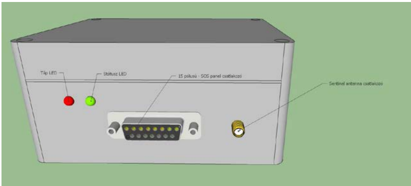
1. ábra: GPS doboz Méretei: 115x90x55mm Súlyja: 340g + 2db csőbilincs 110g
