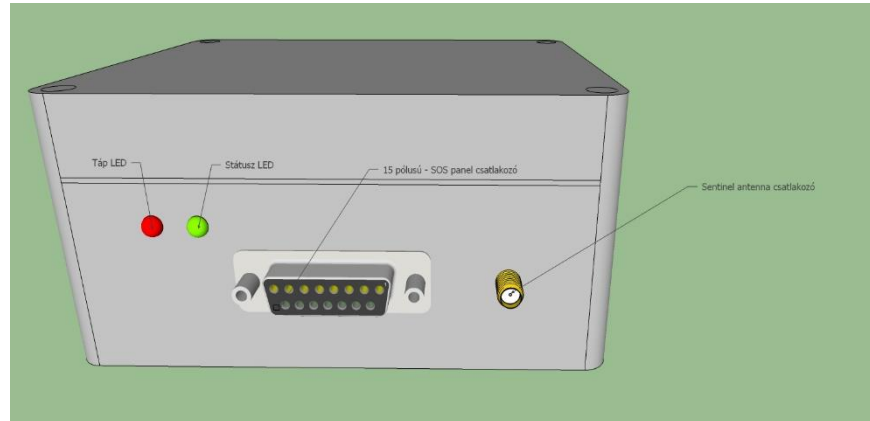
1. ábra: GPS doboz Méretei: 115x90x55mm Súlya: 340g + 2db csőbilincs 110g
