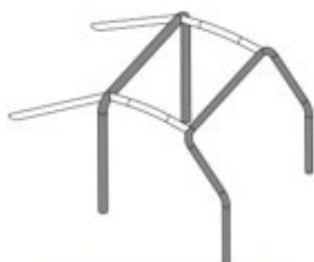
1 főbukócső / main rollbar 1 mellő bukócső / front rollbar
