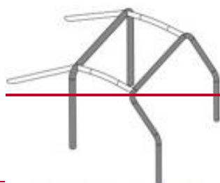
— 1 főbukócső / main rollbar — 1 mellő-bukócső / front rollbar
