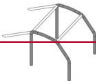
— 2 oldalsó bukócső / lateral rollbars — 2 keresztmerevítő / transverse members — 2 hátsó megtámasztás / backstays
