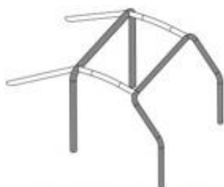
1 főbukócső / main rollbar 1 mellő bukócső / front rollbar
