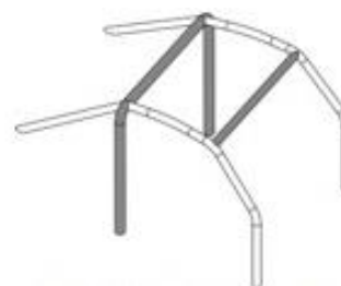
1 főbukócső / main rollbar 2 oldalsó félbukócső / lateral half-rollbars 1 keresztirányú merevítő / transverse member 2 hátsó megtámasztás / backstays
